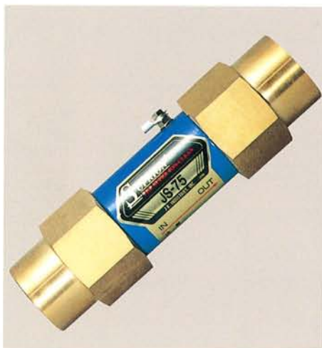
水処理装置 流体静電気方式により水中の鉄分、カルシウム分等をイオン化し、ヒーターなどに付着しにくくし、部品寿命を長くする効果があります。
